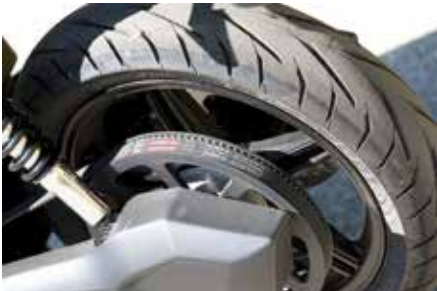
Standardni SK3 ima završni prijenos lancem, a Plus verzija za to koristi remen, koji je tiši i ne traži redovito održavanje
